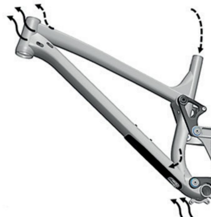
**Kabel der Teleskop-Sattelstütze (Siehe Bild: schwarze gestrichelte Pfeile):**
