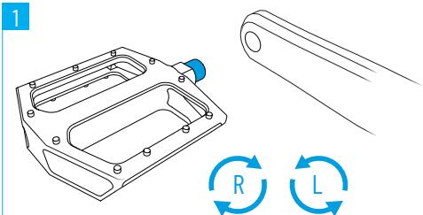
Uno de los pedales tiene la rosca a la derecha y el otro a la izquierda. La mayoría de pedales están marcados con «L» y «R» por el lado de montaje. En algunos, el pedal izquierdo está marcado con una ranura en el eje.
