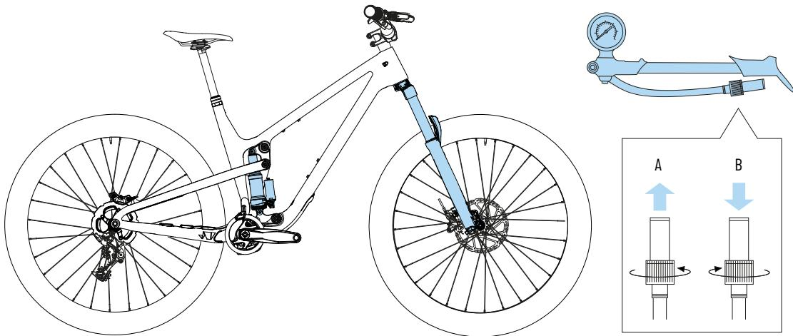
1. Dévissez le bouchon de valve de l'amortisseur / de la fourche de suspension.
