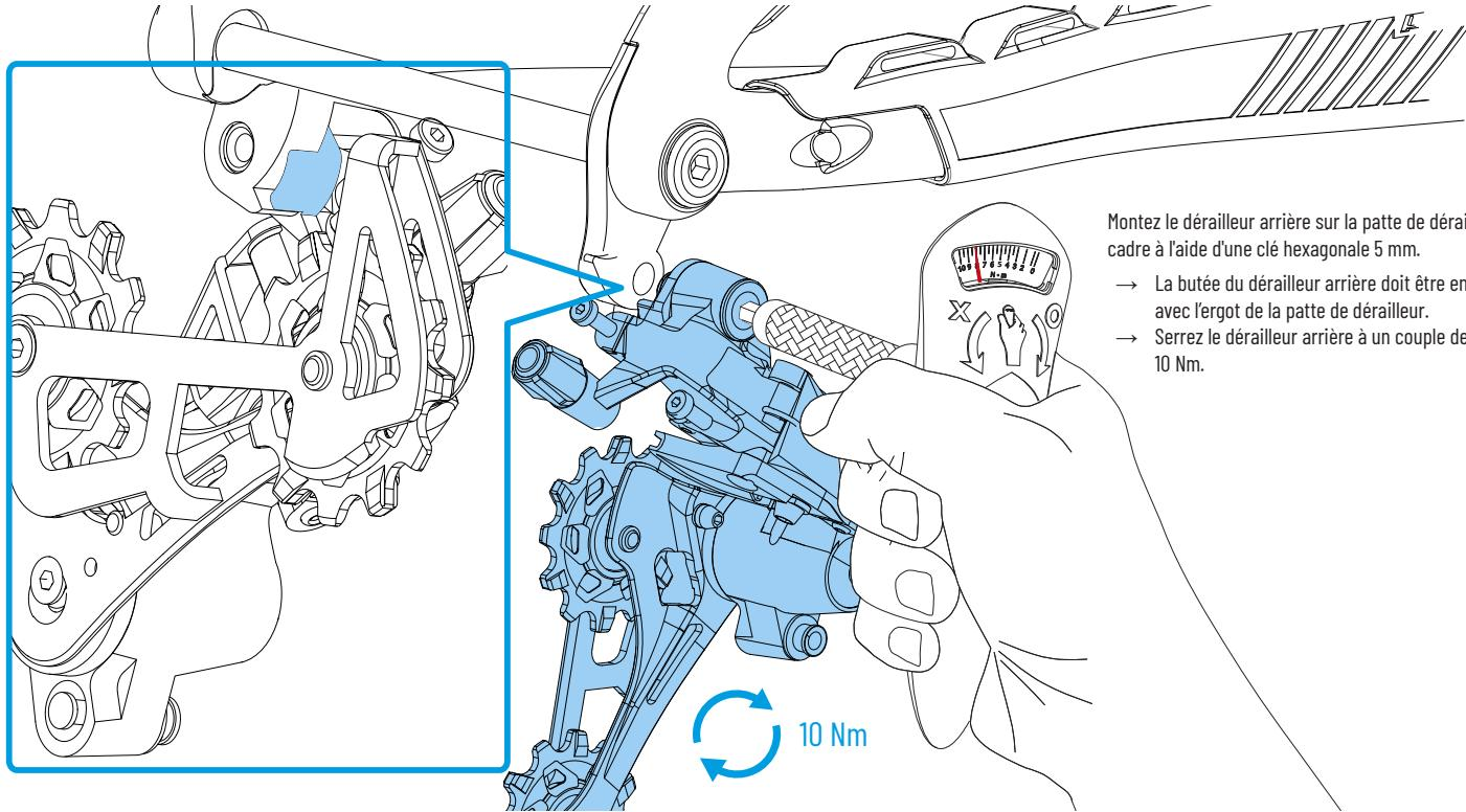
Montez le dérailleur arrière sur la patte de dérailleur du cadre à l'aide d'une clé hexagonale 5 mm.
