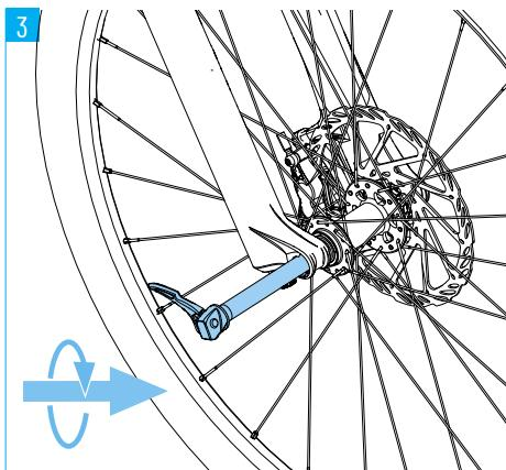
1. Introduce la rueda delantera en los extremos de la horquilla. El disco de freno debe insertarse entre las pastillas de freno.
