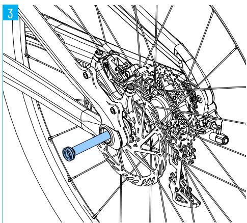
1. Mettez la roue arrière en place dans les pattes d'extrémité du cadre .
