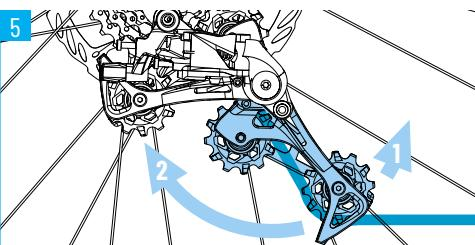
Gira el eje en el extremo con una llave Allen de 6 mm y apriétalo con un par de 12 Nm.
