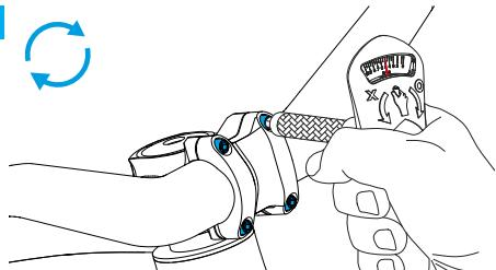
1. Coloca los dos tornillos superiores y apriételos con el par de apriete grabado en láser en la abrazadera o la potencia.
