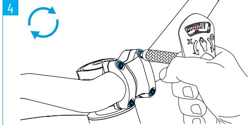
1. Vissez les deux vis de serrage supérieures et serrez-les au couple de serrage gravé au laser sur le collier ou la potence.
