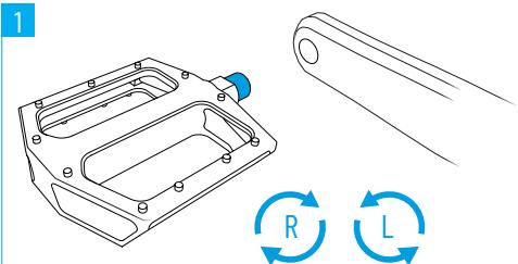
L'une de vos pédales possède un filetage à droite et l'autre un filetage à gauche. Le côté de montage des pédales est généralement identifié par la lettre « L » (gauche) ou « R » (droite). La pédale gauche de certaines pédales est marquée par une rainure dans l'axe.
