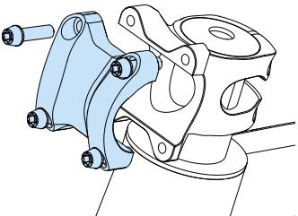
1. Destornilla los tornillos de la abrazadera de la potencia.
