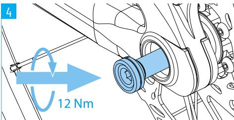
Faites tourner l'axe de roue à l'aide d'une clé hexagonale 6 mm dans les pattes d'extrémité et serrez l'axe de roue à un couple de 12 Nm.
