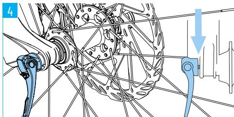
Gira el eje en la rosca del extremo hasta que entre el eje y el extremo tan solo quede un pequeño hueco.
