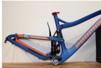
einmal komplett durch. Wenn hierbei kein Kontakt zwischen Rahmen und Federbein festgestellt wird, kann das Federbein verwendet werden. Falls das Federbein verschiedene Hebel oder Einstellschrauben besitzt sollte die Kollisionsprüfung in allen Stellungen der Hebel durchgeführt werden.
